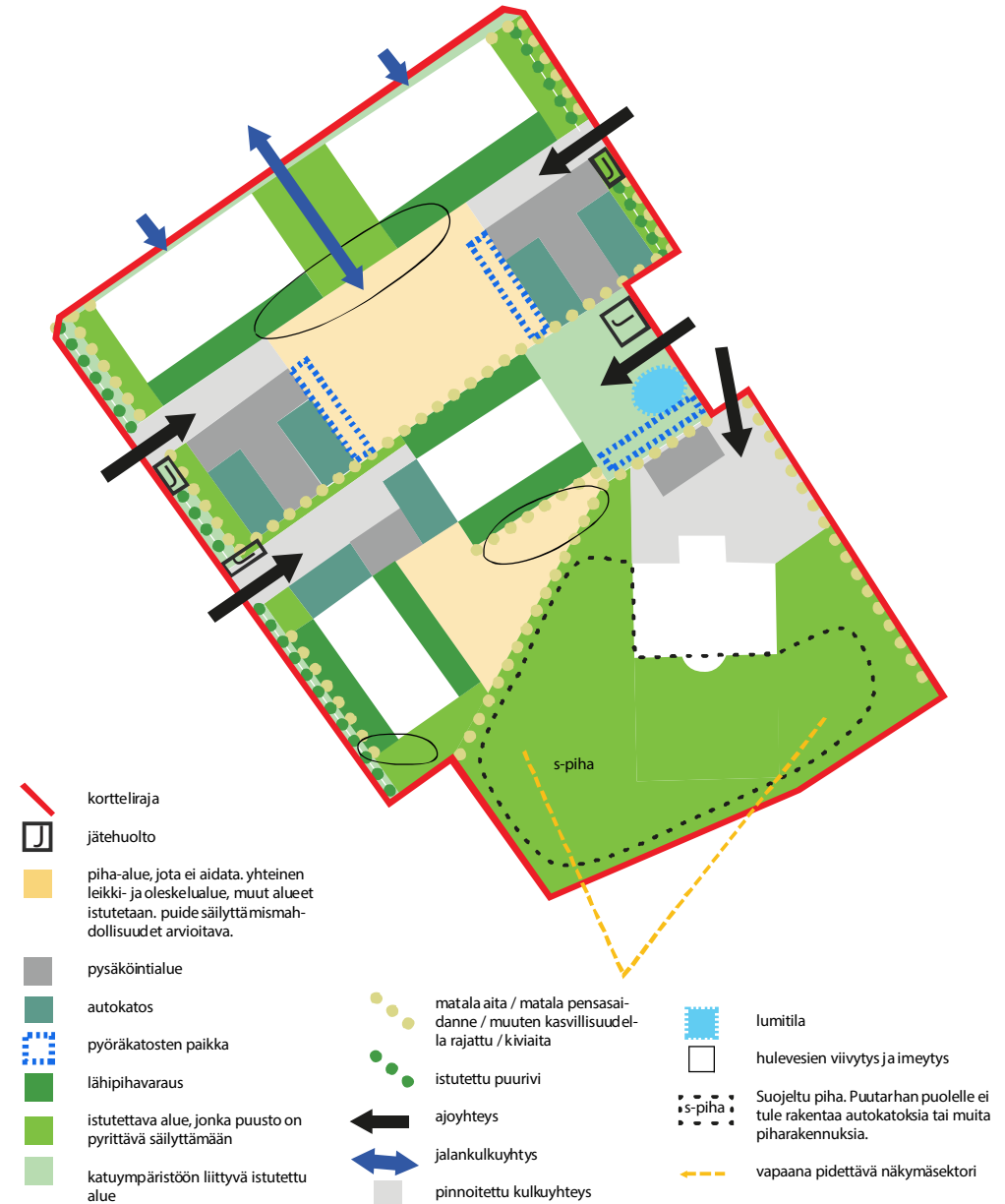
kuva 66. Kaavio piha-alueiden toiminnallisesta järjestelystä.
