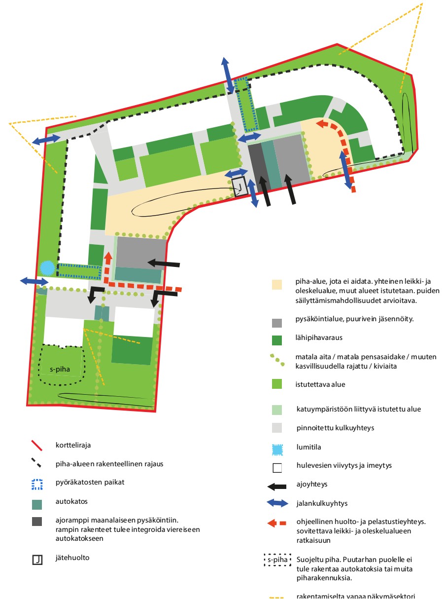
kuva 94. Kaavio piha-alueiden toiminnallisesta järjestelystä.
