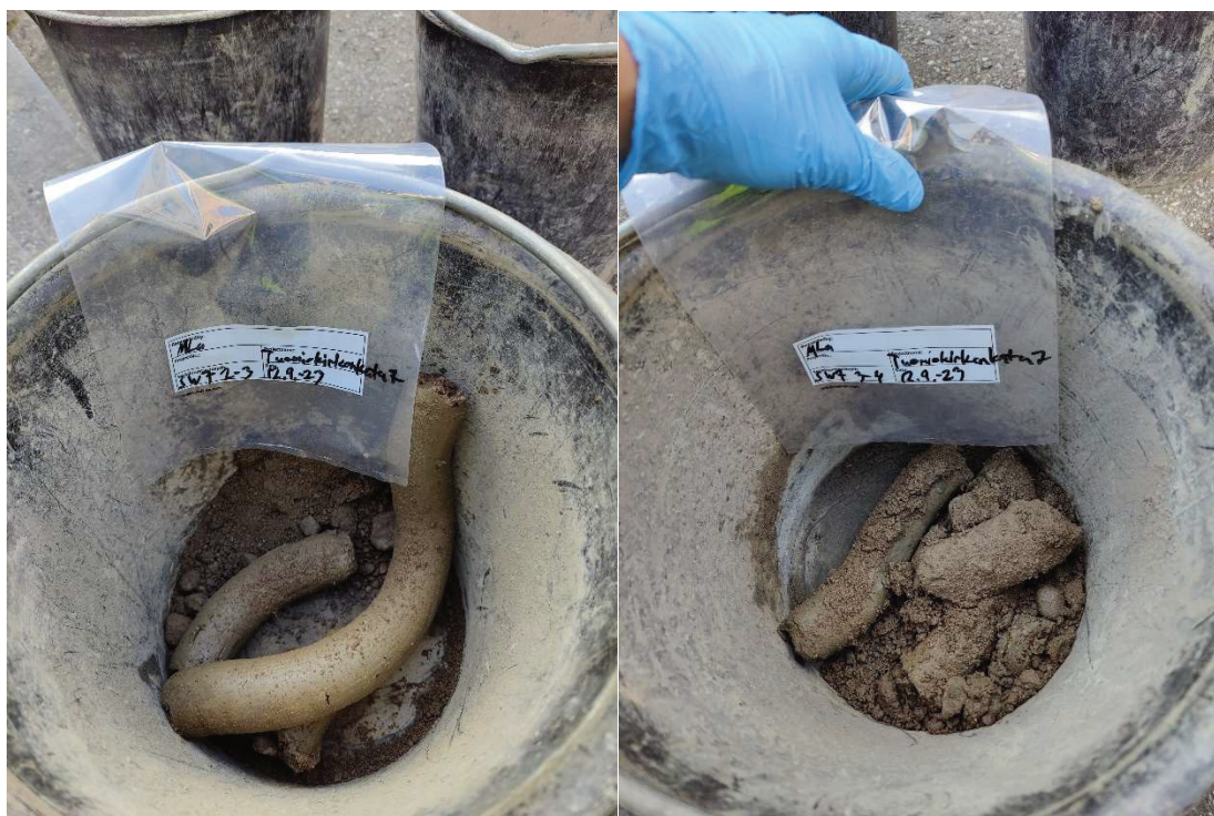
Kuva 12. Näytteet syvyydeltä 2–4 m näytepisteessä SW7. Kaikissa näytepisteissä maa-lajihavainnot tällä syvyydellä olivat vastaavanlaisia.
