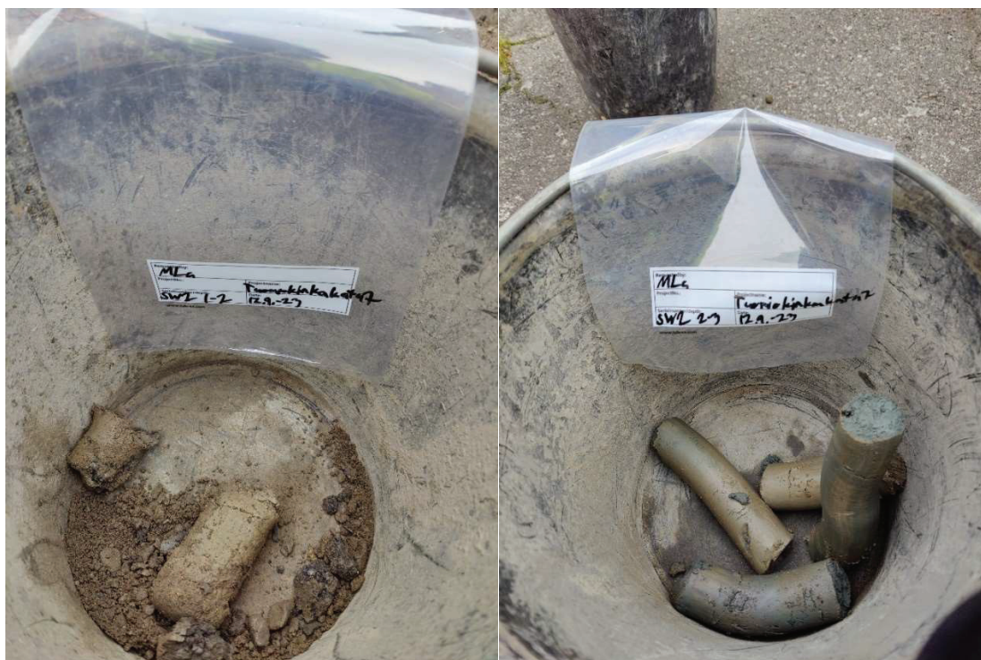
Kuva 3. Vasemmalla SW2 näytekerros, missä todettiin kynnysarvon ylitykset. Oikealla seuraava näytekerros, joka on tiukkaa savea.
