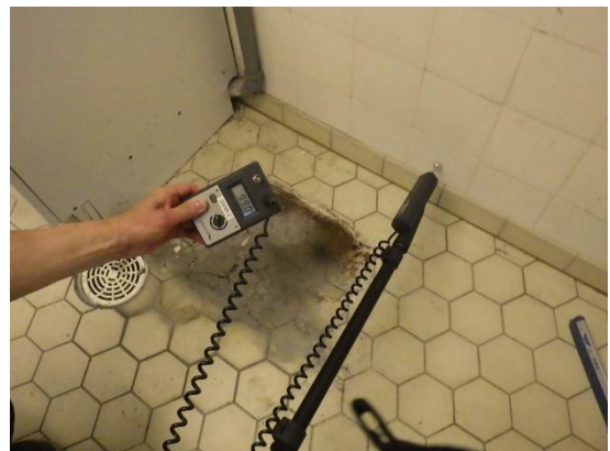
Kuva 15. Maanvastaisilla- ja kantavilla seinälinjoilla havaittiin kohonneita pintakosteus- denilmaisimen lukemia sekä pinnoitevaurioita seinien alaosissa.
