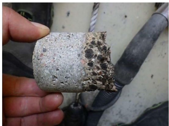
Kuvat 29 a...c. Rakenneavaus RAAP4 tehtiin tilaan 102. Avauksen perusteella rakenne on kevytsorabetonieristeinen kaksoislaatta.
