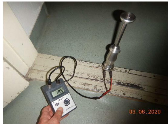
Kuva 14. Kellarikerrosten puukynnyksiä tarkasteltiin piikkianturimittarin avulla. Piikki- mittarilla tarkasteltuna puun kosteuspitoisuudet vaihtelivat välillä 18,5...22,3 paino%. Ylempänä sivukarmien kosteuskokemukset olivat normaalit noin 8 paino%.
