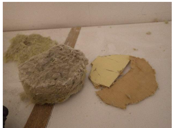
Kuva 70. a. RAUS8 tehtiin vuoden 1990 suunnitelmissa lisälämmöneristettynä esitettyyn ulkoseinään tilassa 128. Seinän sisäpinnassa oli lisälämmöneristeenä 50 mm mineraalivillaa. b. Hirren ja mineraalivillan välissä oli vanha maalattu Enso-pahvi.
