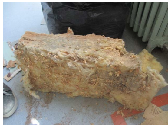
Kuvat 32 a ja b. Alapohjan tasossa hirsien pinnoilla havaittiin laho- ja hyönteisvaurioita muutamien senttimetrien syvyydelle. Poralla koestaen syvemmällä oli kovaa puuta. Rakennuksen alimmat hirsilinjat on kertaalleen uusittu ulkoa käsin. Alin hirsi on poistettu ja korvattu puisilla korotustolpilla (punainen nuoli). Puutolppien välissä on eristevillakaista poistetun hirren paikalla. Alapohjan täyttömateriaalina on hiekkaa ja puulasua. Alapohjan täyttöeristeestä otetussa materiaalinäytteessä ei havaittu mikrobikasvua materiaalissa (MAT1). Kivisokkelin reuna on merkitty sinisellä nuolella. Ulkoseinä-alapohjaliittymästä on 5...10 cm leveä ilmavuoretti alustatilaan.
