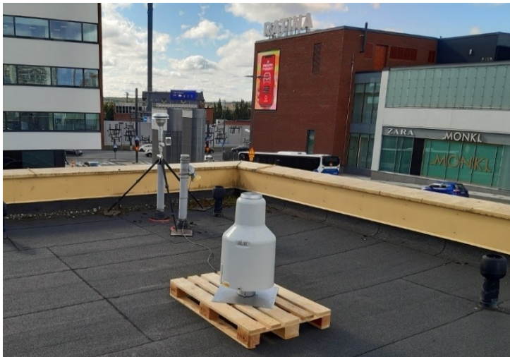
Kuva 1. Taka-alalla katon reunalla hiukkasanalysointorin inlet ja NO x -analysointorin sondi. Etualalla viheralueiden suunnitteluosaston hulevesikertymän seurannassa vuosina 2022-2025 hyödyntämä sademäärämittain.
