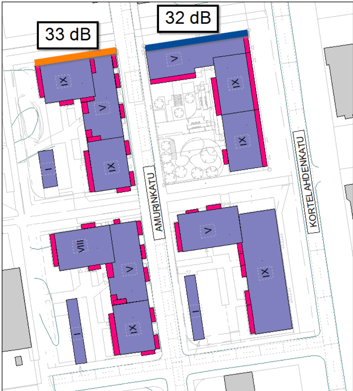
Kuva 2. Julkisivuille muodostuvat 30 dB ylittävät suositukset ulkovaipan äänitasoerovaatimuksiksi \Delta L_{A,vaad} . Esitetyt vaatimukset aiheutuvat yöajan hetkellisistä enimmäisäänitasoista.
