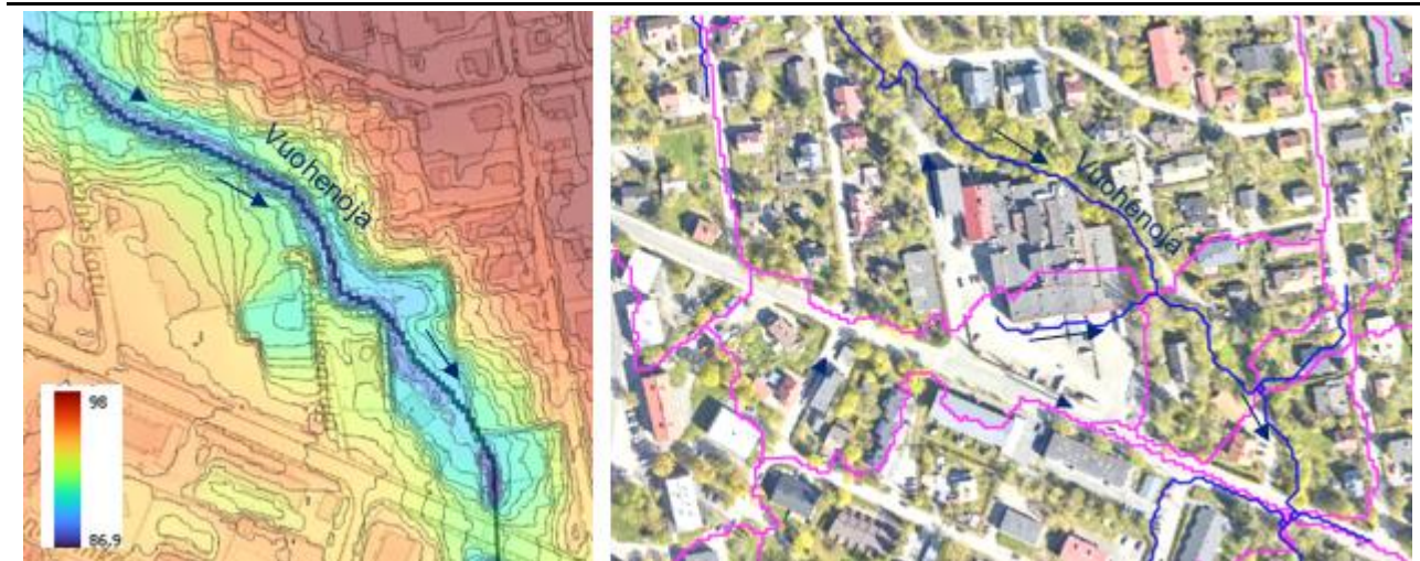
Kuva 2.2. Korkeustasot havainnollistettuna vasemmalla ja oikealla valuma-alueet (magenta) pintavaluntareitteineen (sininen) kohti Vuohenojaa MML:n 2x2 pintamallin perusteella.
