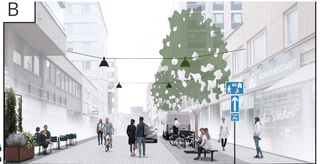
Kivetty ajorata Kynnyksetön kouru Joustoalue Kivetty jalkakäytävä
