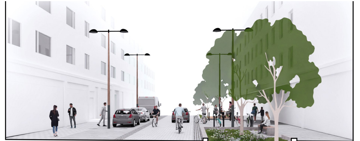
Kivetty jalkakäytävä Kapea joustoalue Kivetty ajorata Leveä joustoalue Kivetty jalkakäytävä
