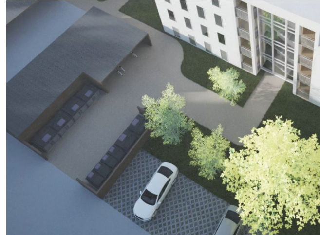
Esimerkki jätehuollon syväkeräysastioiden ryhmästä, joka on sijoitettu polkupyöräkatoksen ja pysäköintipaikkojen väliin ja viimeistelty selkeästi rajatuksi kokonaisuudeksi.
