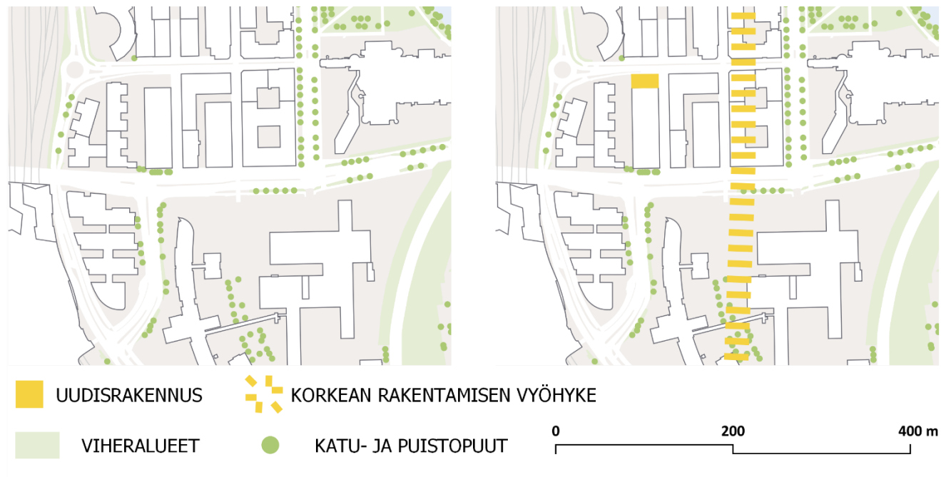
Kuva 3 Rakennuksen sijainti korttelirakenteessa. Vasemmalla on esitetty lähtötilanne ja oikealla asemakaavamuutoksen mukainen uusi korkea rakentaminen. Lisäksi molemmissa kuvissa on esitetty yleisten alueiden viheralueet ja puusto.
