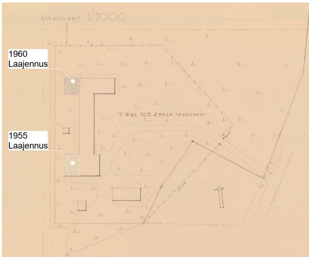
Kuva 18. Asemapiirrosote, 1960. Lisätty rasterit ja selitteet laajennuksista.
