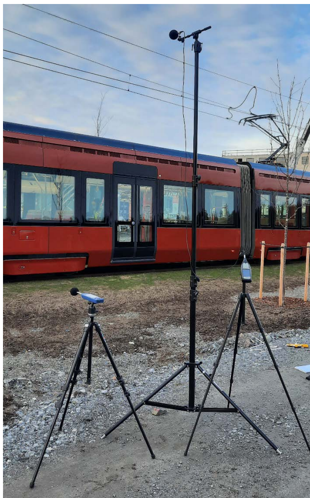
Kuva 1. Mittaukset toteutettiin Norsonic 145 ja B&K 2250 light äänitasomittareilla.
