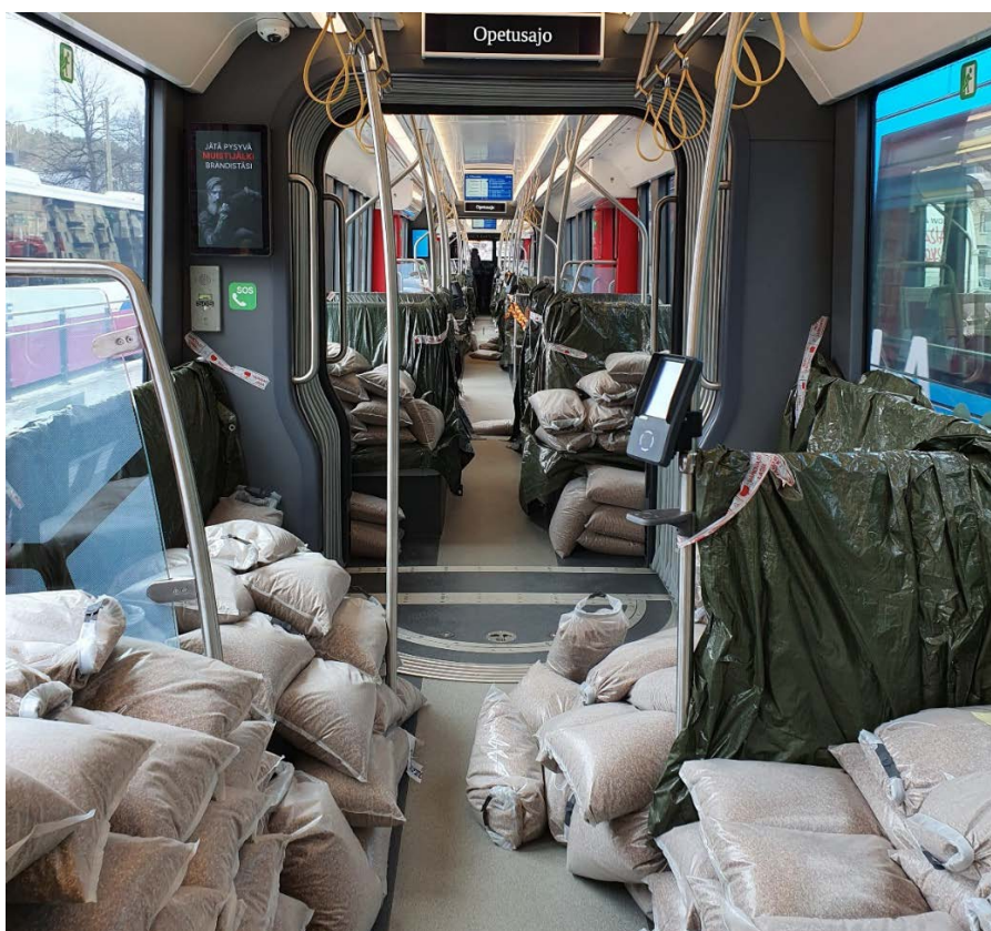
Kuva 2. Mittauskohteena toiminut raitiovaunu TRO06 lastattiin hiekkasäkein vastamaan korkeimman matkustajakapasiteetin tilannetta.
