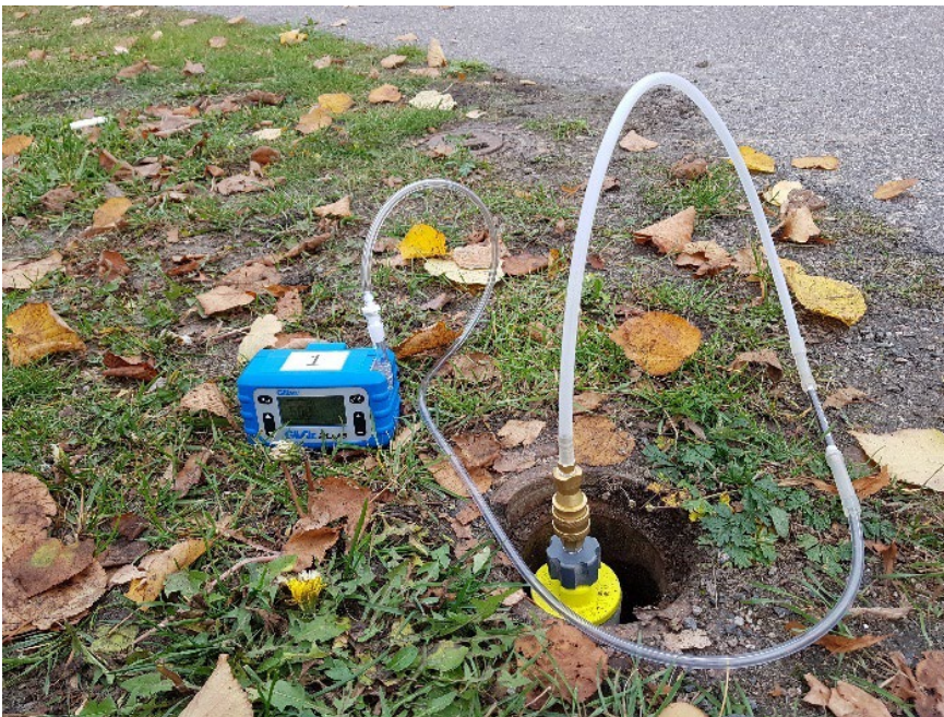
Kuva 14. Esimerkki huokosilmanäytteenotossa käytettävästä pumpusta ja korkista (aktiivimenetelmä).
