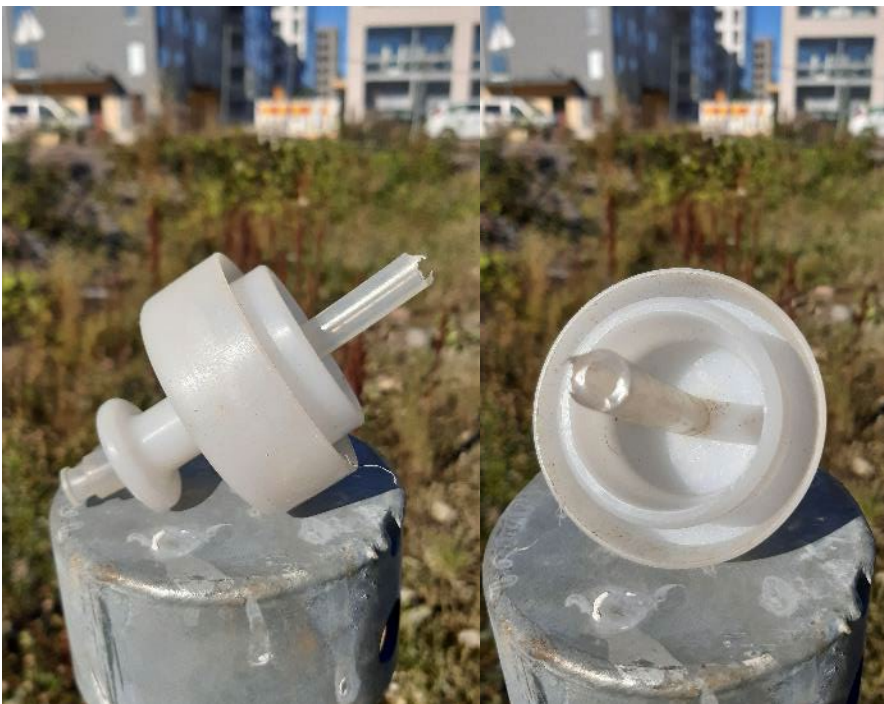
Kuvat 4a+b. Huokosilmaputken korkkiin voidaan porata läpivienti aktiivinäytteenoton letkuasennusta varten.
