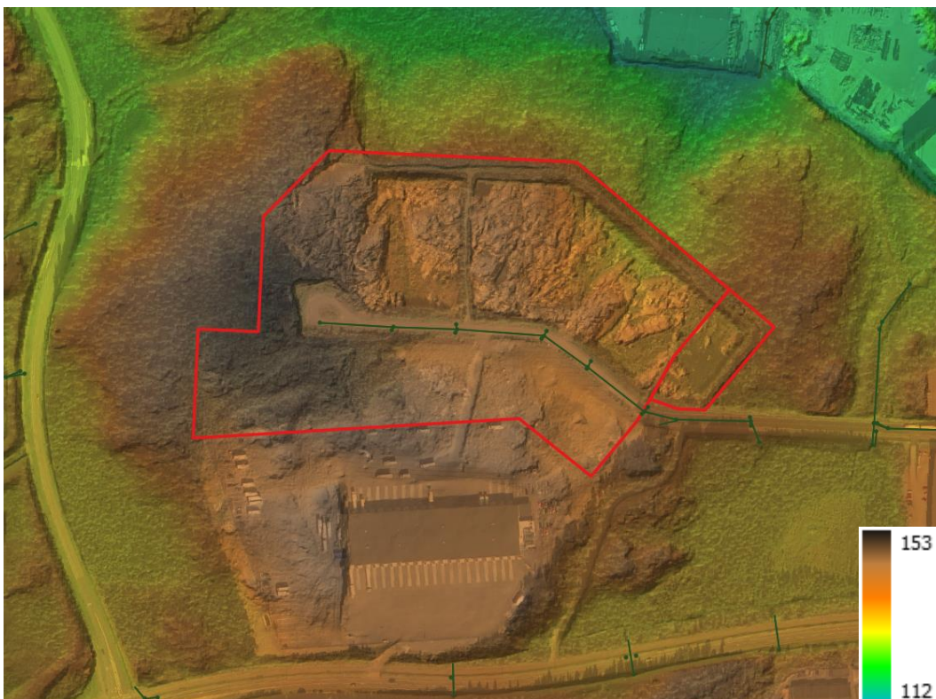
Kuva 2.11. Alueen topografia ja hulevesiverkostot (Lähde: Google satellite, Tampereen kaupungin korkeusmalli 2022)
