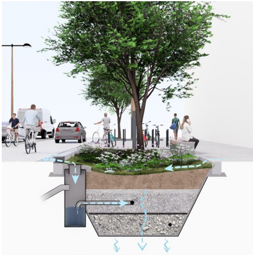
Kuva 3.1. Esimerkki biosuodatusrakenteesta, johon vettä ohjataan sekä suoraan pintoja pitkin, että kaivon kautta salaojalla kasvualustaan.
