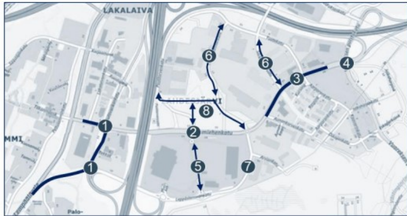
Kuva 10 Alueen katuverkolle suositeltavia toimenpiteitä. Numerot viittaavat sivun vastaaviin tekstikohtiin.
