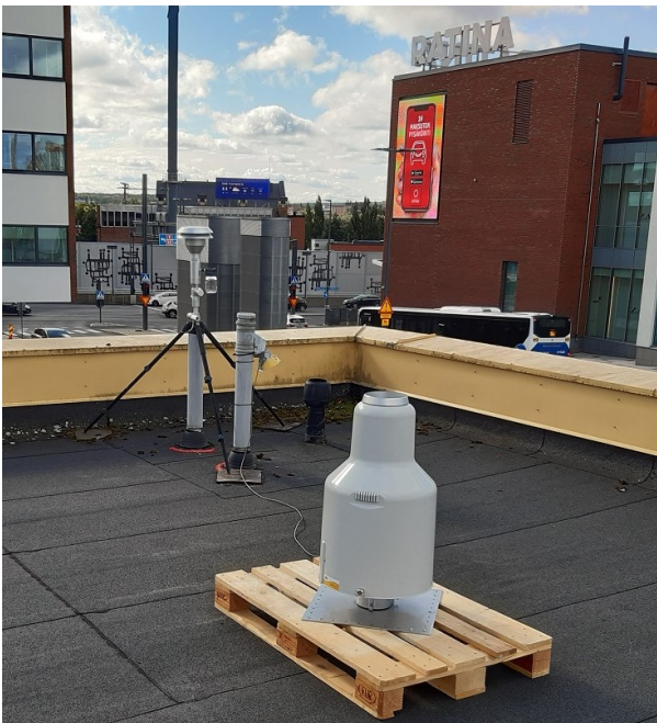
Kuva 4. Linja-autoasemalla jatketaan ilmanlaadun mittauksia aiempaan tapaan, etualalla kaupungin viheralueet ja hulevedet -yksikön sademäärämittain.
