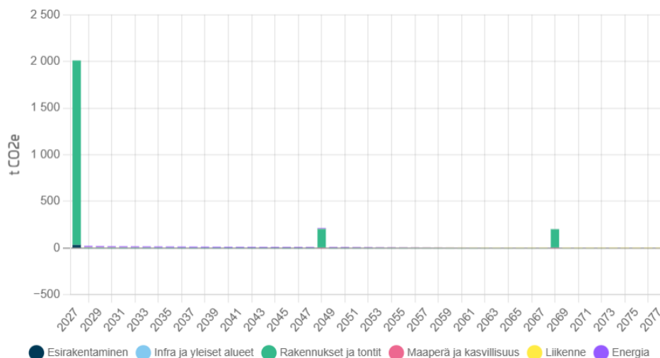
Kuva 23 Tulokset vuositasona. Diagrammista voidaan todeta, että rakentaminen tuottaa hankkeen alussa pääosan päästöistä. Myöhemmät päästöt syntyvät rakennuksen korjaamisesta.
