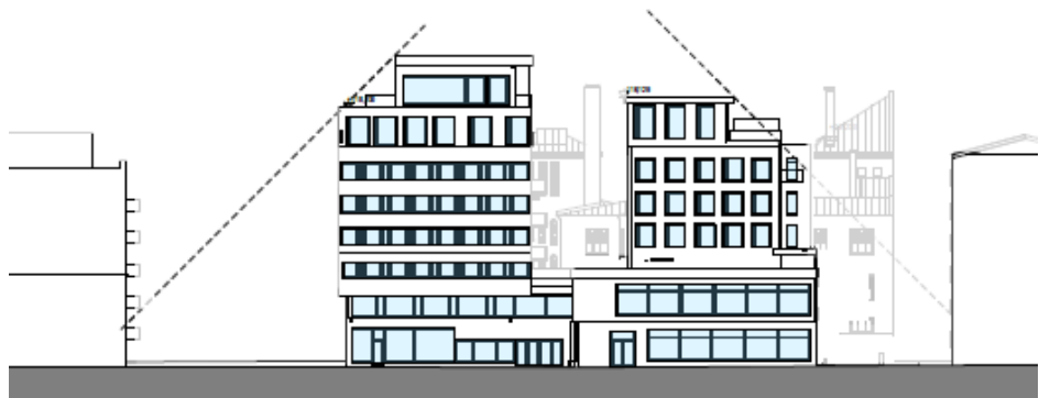
Kuva 12 Viitesuunnitelman julkisivu etelään Puutarhakadulle. Kuvassa on esitetty valokulmatarkastelu, jonka avulla voidaan havainnollistaa uudisrakentamisen vaikutusta viereisten asuinrakennusten valoisuuteen. Ekman Arkkitechdit 2025.
