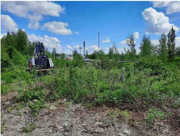
Kuva 24. Kairakone tutkimuspisteellä S30 maanlähjitysalueella. Keskellä pohjavesiputki 810.
