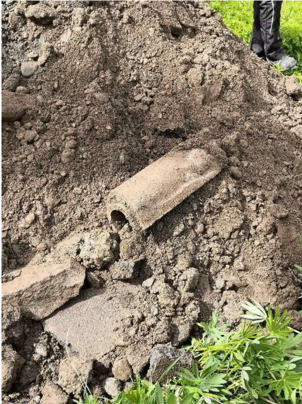
Kuva 11. Koekuopassa VAH8 mm. betonia ja asfaltinkappaleita.
