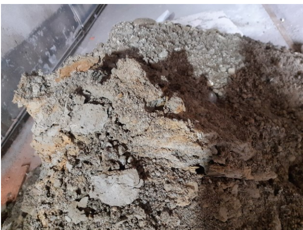
Koekuopan VAH3 maa-ainesta. Hiekka/siltti.
