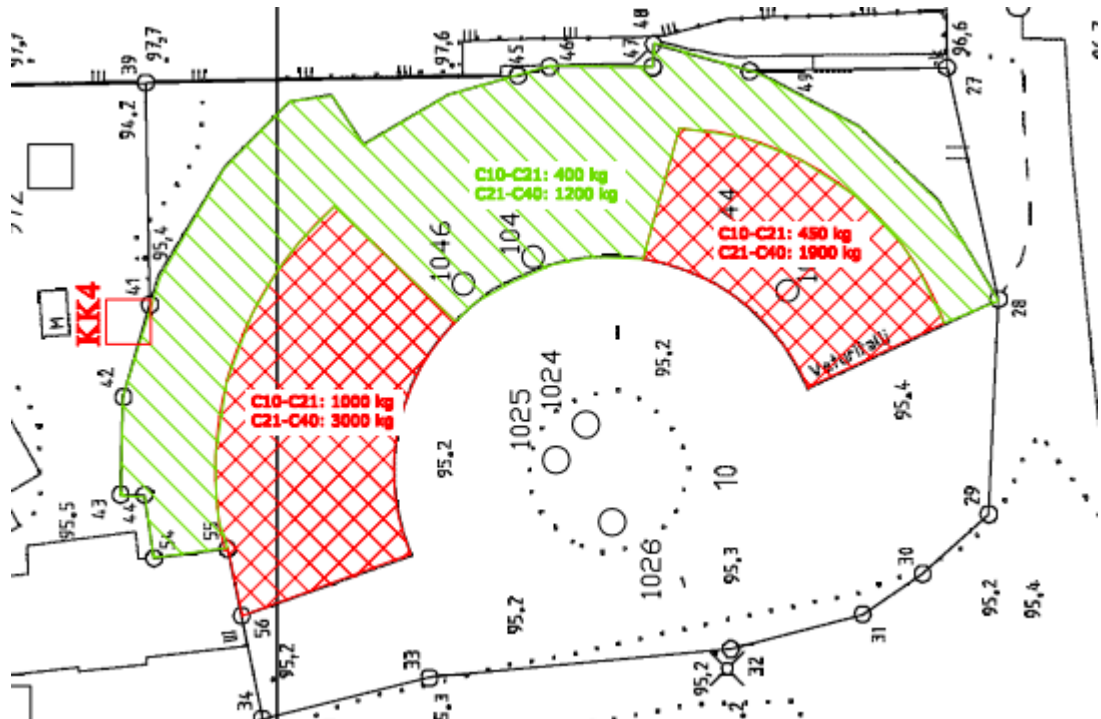
Kuva 3 Pilaantuneet alueet 0,5–1m (Kunnostuksen yleissuunnitelma, KOy Tampereen Torni-hotelli/ Tampereen kaupunki Veturitallit ja Ratapihankatu, Ramboll Finland Oy 2012
