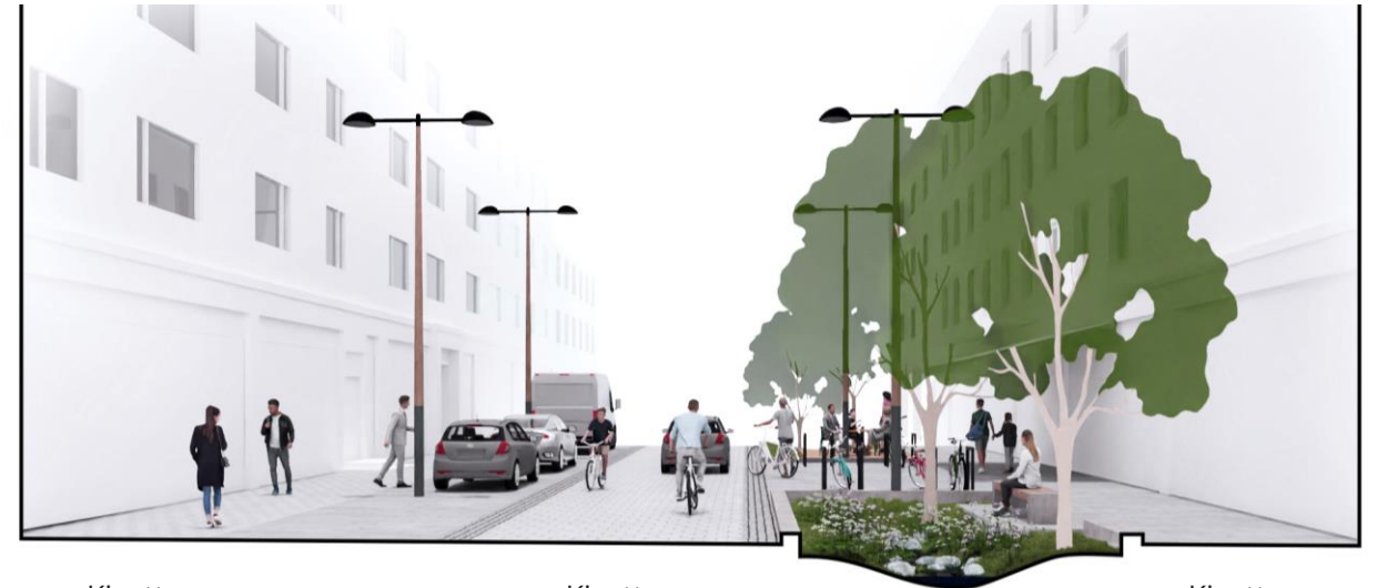
Kivetty jalkakäytävä 3 m Kapea joustoalue 3 m Kivetty ajorata 4 m Leveä joustoalue 4,5 m Kivetty jalkakäytävä 3 m
