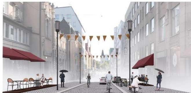
Joustoalue 2 m Reunakivi 8-10 cm Kivetty ajorata 4 m Joustoalue 3 m Kivetty jalkakäytävä 2 m
