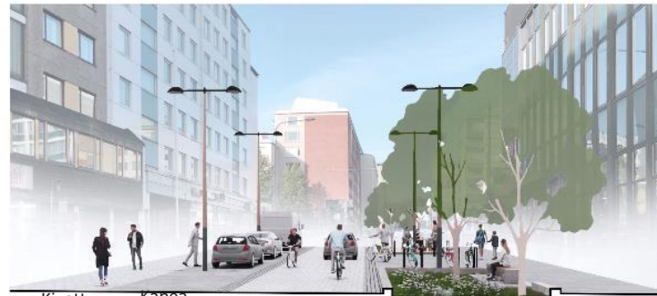
Kivetty jalkakäytävä 3 m Kapea joustoalue 3 m Kivetty ajorata 4 m Leveä joustoalue 4,5 m Kivetty jalkakäytävä 3 m
