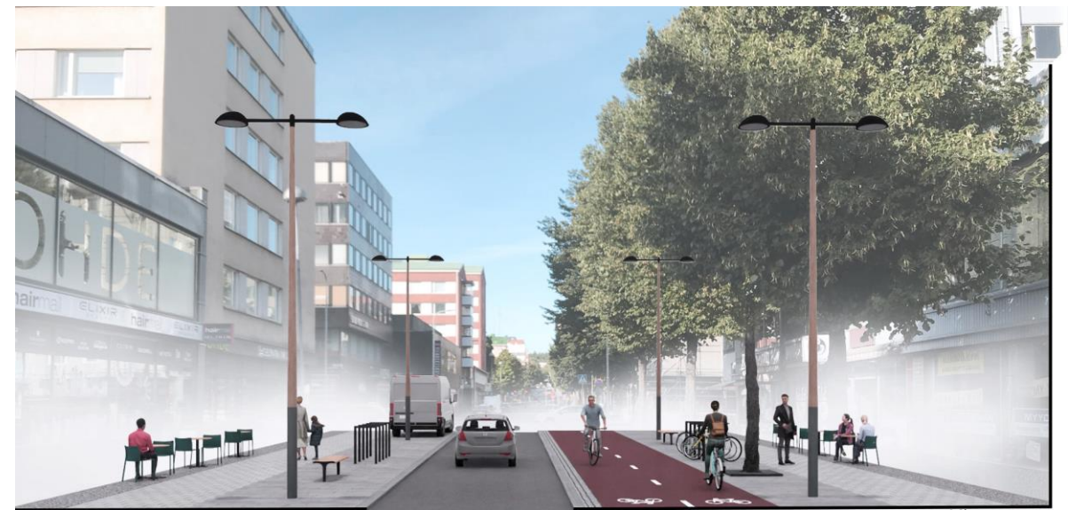
Kivetty jalkakäytävä 3 m Joustoalue 3,0 m Asfaltoitu ajorata 3,5 m Pyörätie 3 m Joustoalue 2 m Kivetty jalkakäytävä 3 m
