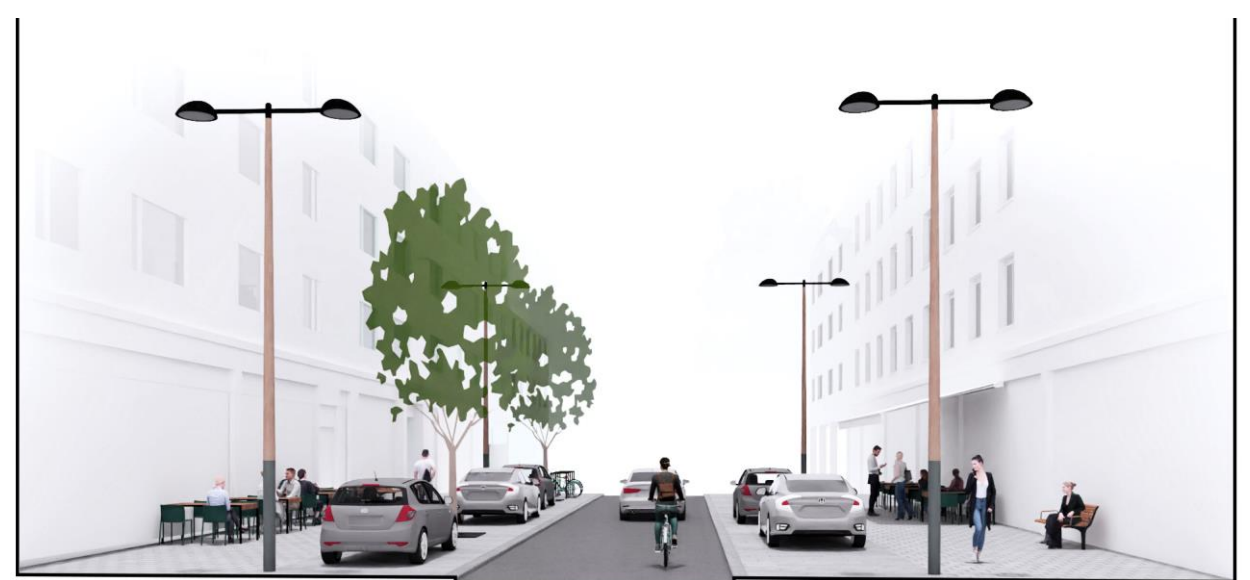
Kivetty jalkakäytävä 4 m Joustoalue 3 m Matala reunakivi (3 cm) Asfaloitu ajorata 4 m Joustoalue 3 m Kivetty jalkakäytävä 4 m
