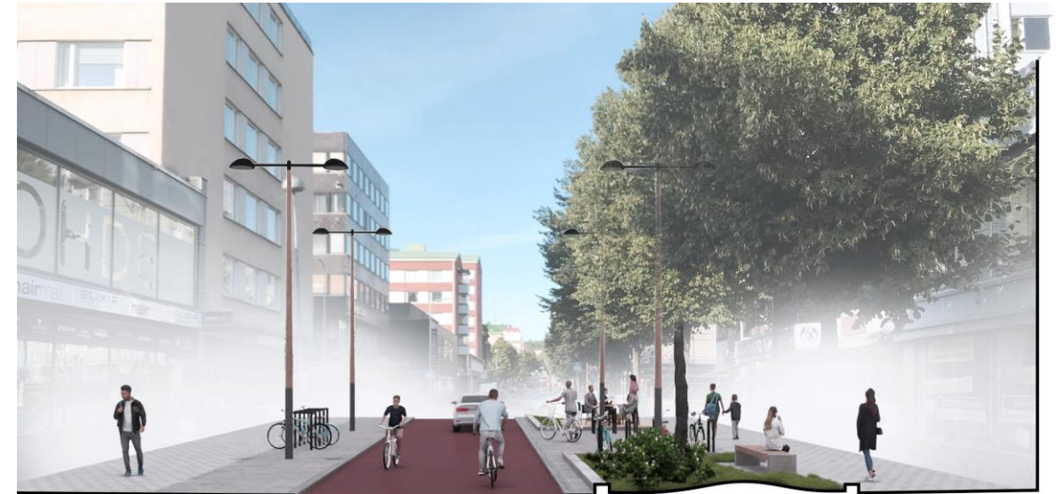
Kivetty jalkakäytävä 3 m Joustoalue 2,5 m Asfaltoitu ajorata 4,5 m Joustoalue 4,5 m Kivetty jalkakäytävä 3 m
