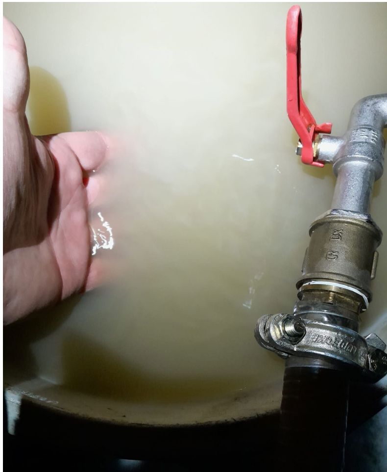
Kuva 4: Porakaivon PK1 vesi oli hyvin sameaa ja hienojakoista mineraaliainesta sisältävää, eikä se kirkastunut missään vaiheessa pumppaustestien aikana, mikä johtuu todennäköisesti kallioperän pintaosan rikkonaisuuksien kautta kaivon kulkeutuvista louhimoalueen pintavesistä.
