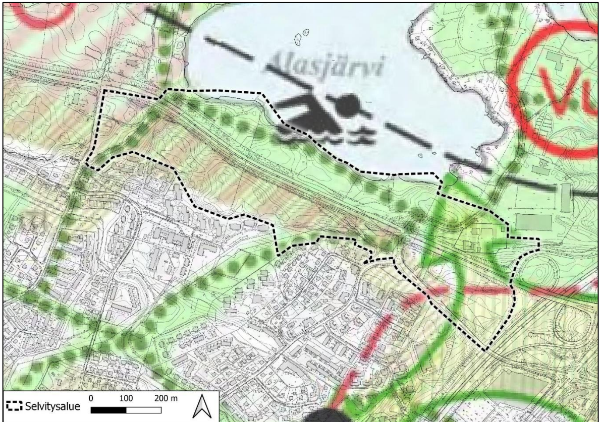
Kuva 24. Ote Kantakaupungin yleiskaavasta 2040 selvitysalueen ympäristössä. keskuspuistoverkosto on esitetty vaaleanvihreänä ja ohjeellinen virkistysyhteys vihreällä pisteiviivalla. Ohjeellinen ekologinen yhteys on esitetty kellertävän vihreällä kenoviivoituksella, asumisen ja virkistykseen sekoittunut alue punavihreällä kenoviivoituksella. Ohjeellinen viherverkoston yhteystarve on osoitettu vihreällä nuolella.
