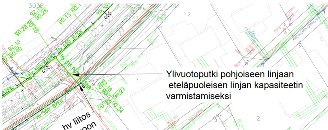
Kuva 2: Kannistonkadun kohdalle tuleva ylivuotoputki pohjoiseen hulevesilinjaan.
