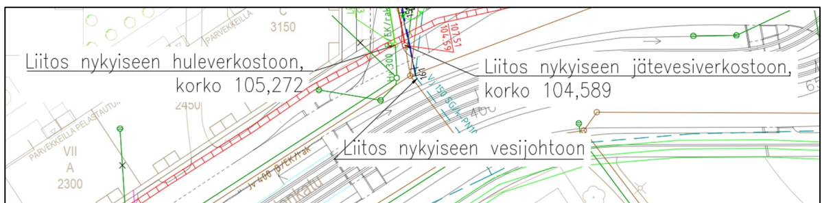
Kuva 5: Männistönkujalle rakennettavien vesihuoltolinjojen liitoskohdat nykyisiin verkostoihin.
