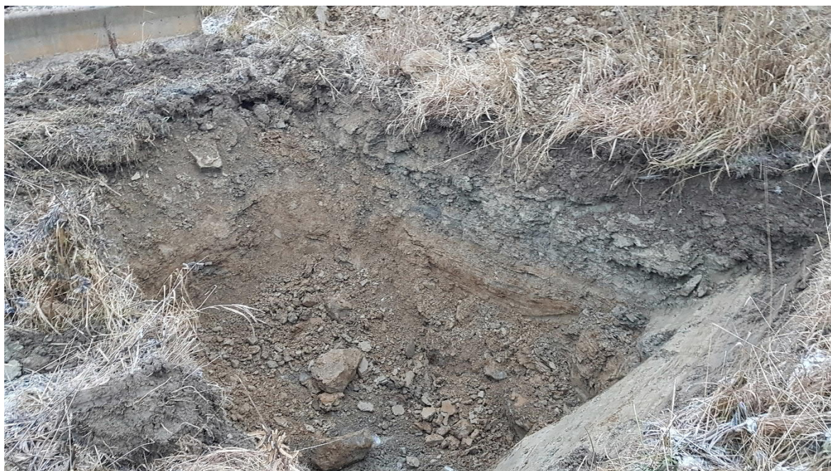
Kuva 3. Kaivanto KKA2. Maalaji pääosin savea ja moreenia.
