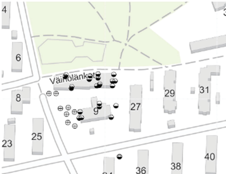
Kuva 2.2. Alueen maaperä on kartoittamatonta (vasemmalla). Oikealla näkyy kiinteistöllä tehdyt paino- ja tärykairauskohdat.
