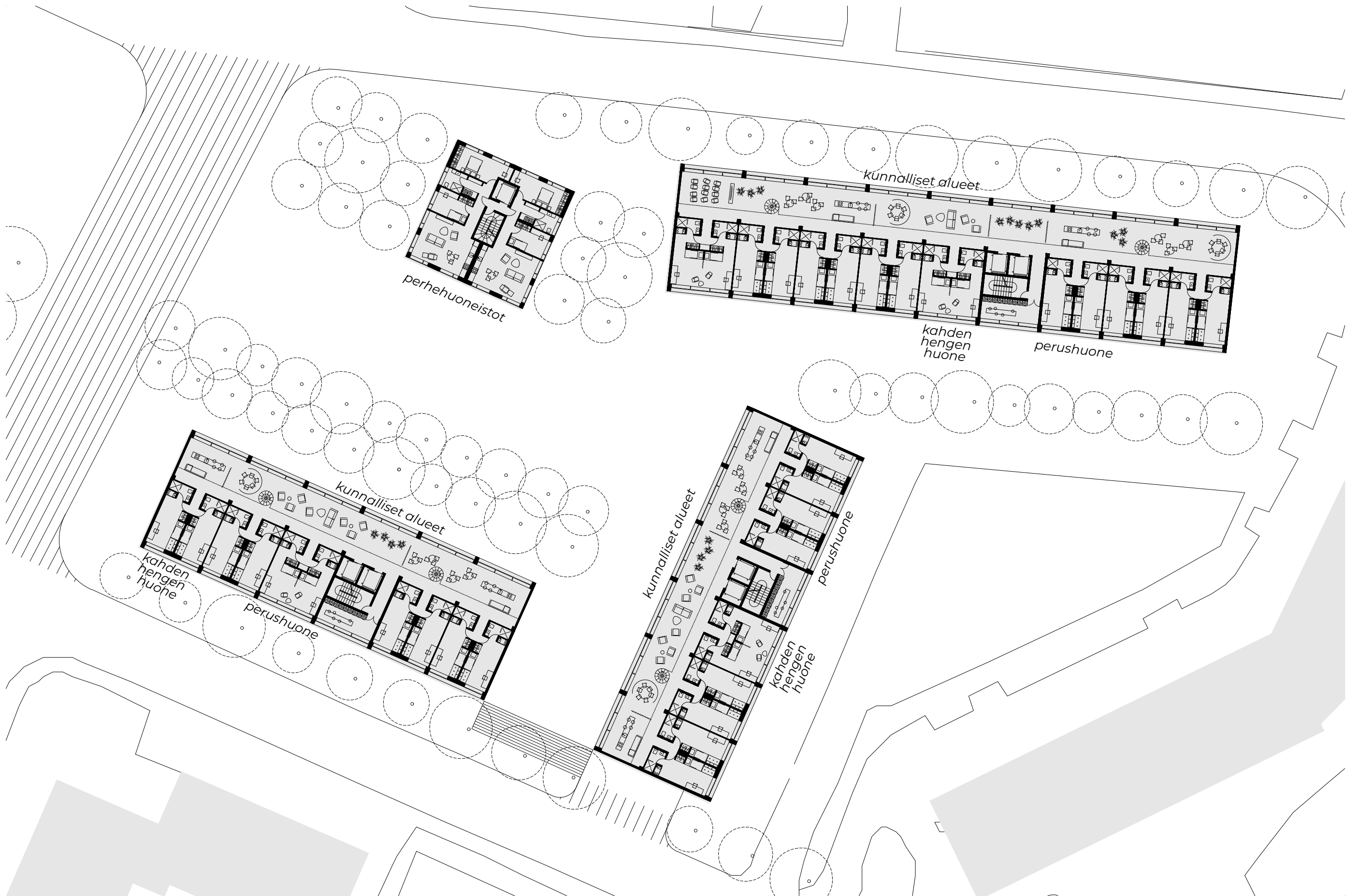
huonetyypit voidaan järjestää vapaasti modulaarisen järjestelmän mukaan Vakio pohjapiirros 1:400
