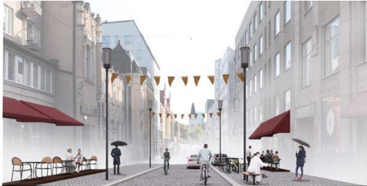
Kivetty jalkakäytävä 4 m Reunakivi 8-10 cm Nupukivinen ajorata 5 m Reunakivi 8-10 cm Joustoalue 3 m Kivetty jalkakäytävä 2 m
