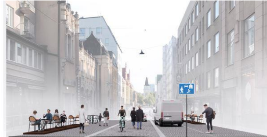
Nupukivinen ajorata 8 m Kynnyksetön kouru Joustoalue 3 m Kivetty jalkakäytävä 3 m
