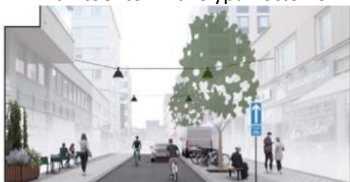
Kivetty jalkakäytävä 3 m Matala reunakivi (3 cm) Asfaloitu ajorata 4 m Joustoalue 2,5 m Kivetty jalkakäytävä 2,5 m
