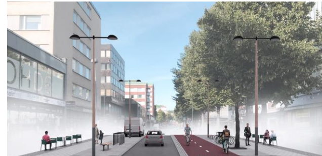
Kivetty jalkakäytävä 3 m Joustoalue 2,5 m Asfaltoitu ajorata 3,5 m Pyörätie 4 m Erotusalue 0,5 m Joustoalue 2 m Kivetty jalkakäytävä 2,5 m
