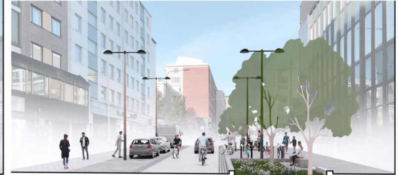
Kivetty jalkakäytävä 3 m Kapea joustoalue 3 m Kynnysetön reunakivi Kivetty ajorata 4 m Kynnysetön reunakivi Leveä joustoalue 4,5 m Kivetty jalkakäytävä 3 m
