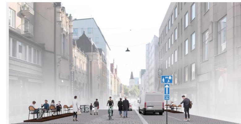
Nupukivinen ajorata 8 m Kynnyksetön kouru Kynnyksetön kouru 3 m Joustoalue 3 m Kivetty jalkakäytävä 3 m
