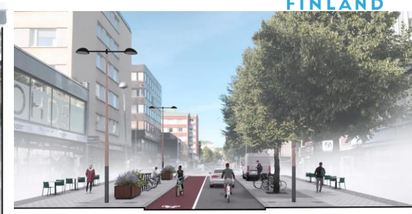
Kivetty jalkakäytävä 3,5 m Joustoalue 3,0 m Pyöräkaista 2,0 m Asfaltoitu ajorata 3,0 m Joustoalue 3,0 m Kivetty jalkakäytävä 3,5 m
