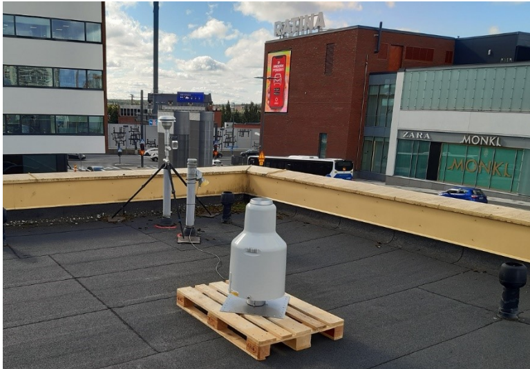
Kuva 1. Taka-alalla katon reunalla hiukkasanalysointin inlet ja NO x -analysointin sondi. Etualalla viheralueiden suunnitteluyksikön hulevesikertymän seurannassa vv. 2022 - 2023 hyödyntämä sadevesimittain.
