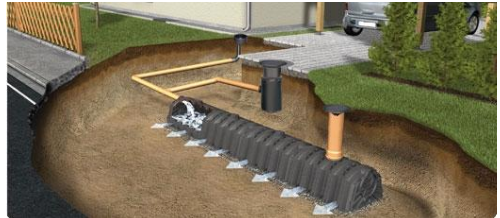
Esimerkki pientaloon soveltuvasta hulevesijärjestelmästä.
