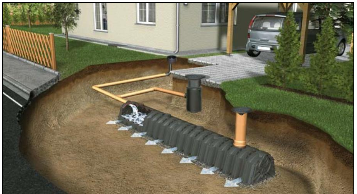
Kuva 27. Esimerkki maanalaisesta kennostosta omakotitontilla. 17
