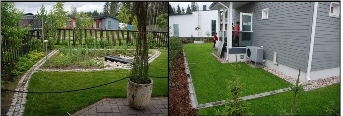
Kuva 25. Omakotitalon hulevedet johdetaan maanpäällisin kouruin tontin kulmassa olevaan sadeputarhaan, joka mahdollistaa hulevesien hetkellisen lammikoitumisen. (Tampere, Vuores).
