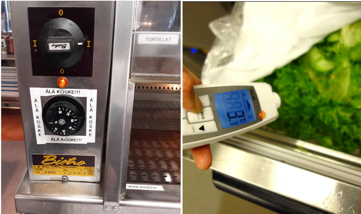
Kuvat 6 ja 7. Lämpötilan säätimiä tarkastuskohteessa (lämpötunneli) ja lämpötilan mittausta.
