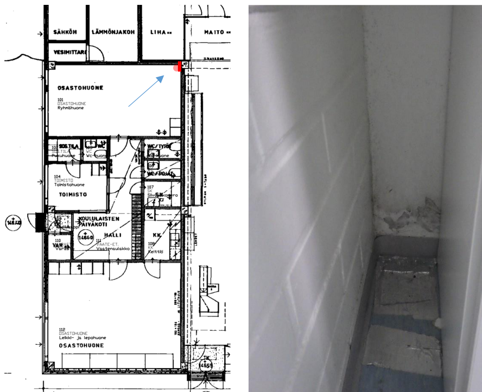
Kuva 6 a ja b. Vasemmalla kuva (a) viikareiden tilojen kosteuskartoituksesta ja oikealla kuva (b) paikasta, jossa havaittiin kohonneita arvoja pintakosteusilmaisemella ja viiltomittauksella.
