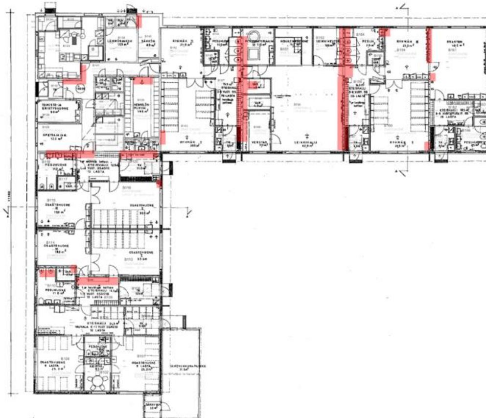
Kuva 5. Kosteuskartoitus pintakosteusilmaisimella. Kuvaan on punaisella merkitty lattiassa todettu poikkeavat pintakosteusilmaisimen lukemat.
