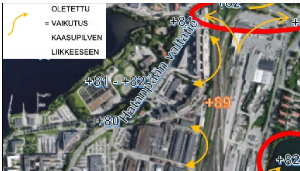
Kuva 6. Rakennusten mahdollinen vaikutus tuulen ja kaasuvirtausten etene- miseen.
