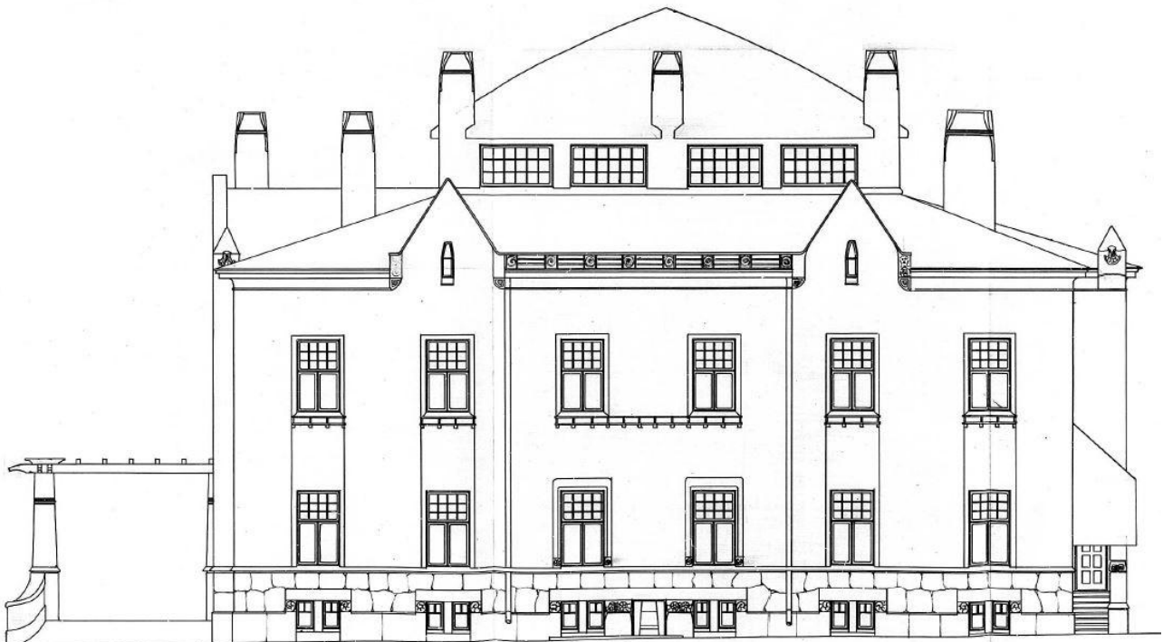
Julkisivu itään. Sivü on rakennuksen symmetrisin. Julkisivun yläosassa on koristenauha tai -kaide ja ikkunoiden alle on piirretty kukkalaatikot.
