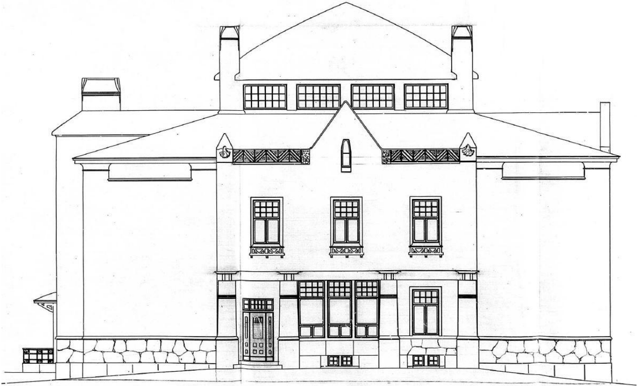
Julkisivu etelään. Pääovi on pienessä syvennyksessä, sen edustalla on pergola. Julkisivun yläosassa on koristenauha tai -kaide ja ikkunoiden alla kukkalaatikot.
