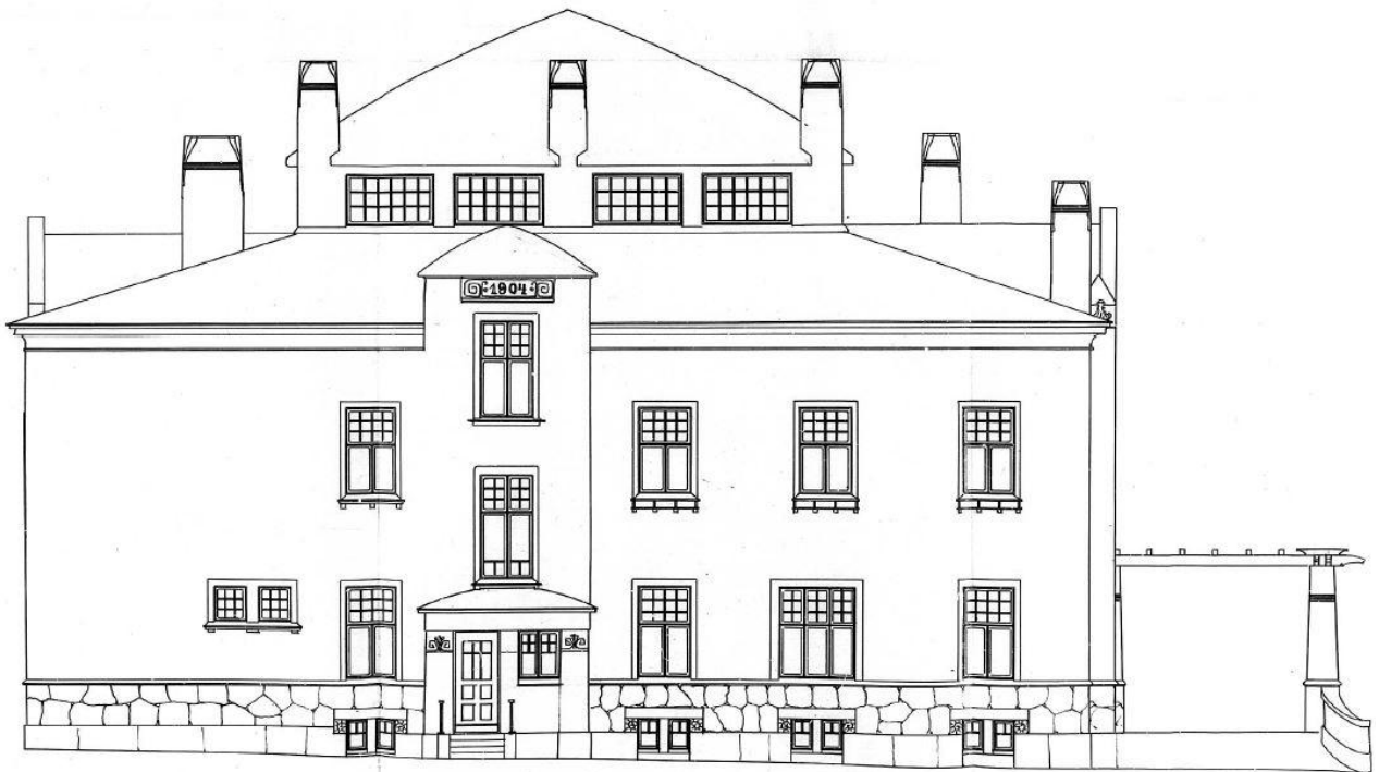
Julkisivu länteen. Sisäänkäynti vie porrashuoneeseen (porras A). Porrashuoneen yläosa on tornimainen ja siihen on suunniteltu ikuistettavaksi talon rakennusvuosi.
