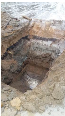
Kuva 1. Koekuopan KK1 maalajikerrokset
