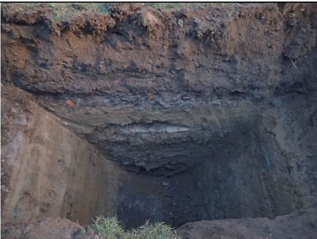
Kuva 4. Koekuopan KK4 maalajikerrokset.
