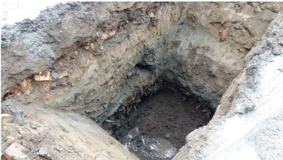
Kuva 3. Koekuopan KK3 maalajikerrokset
