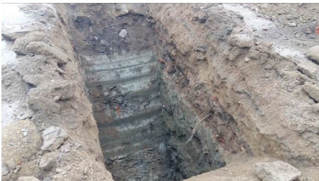
Kuva 2. Koekuopan KK2 maalajikerrokset
