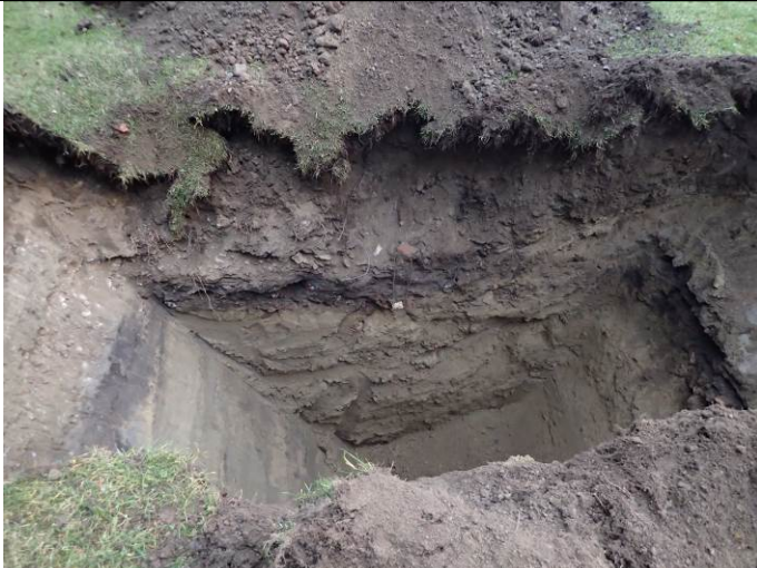
Kuva 5. Koekuopan KK5 maalajikerrokset
