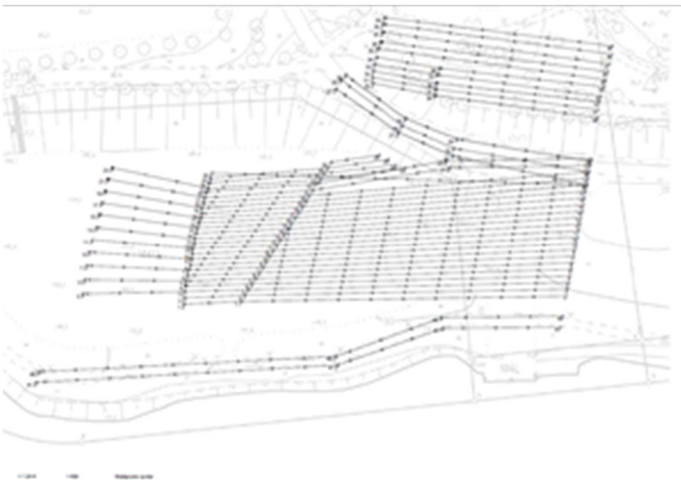
Kuva 15. Frenckellin kalkkiruukin alueelle mitatut maatutkaluotauslinjat.
