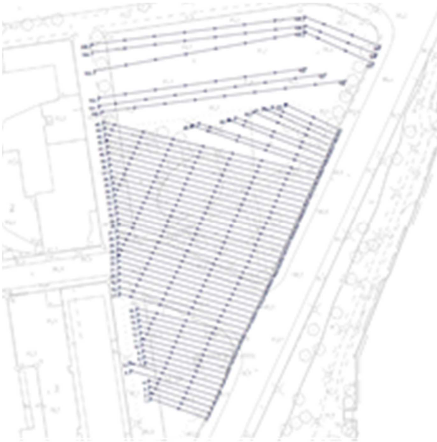
Kuva 14. Nalkalan tiiliruukin alueen maatutkaluotauslinjat.
