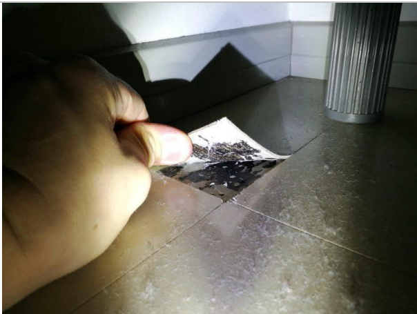
pistokoetarkastus B120 pikiliimaa lattian pinnoitteen alla
