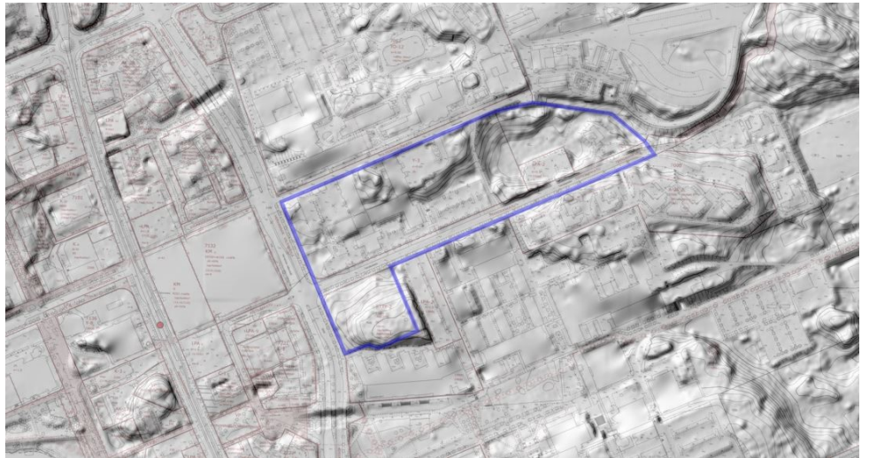
Kuva 1: Suunnittelualueen topografia rinnevarjostuksena. Alue on korkeussuhteiltaan pienipiirteistä ja vaihtelevaa. Korkeusasema suunnittelualueella vaihtelee 141–150 mmpy. Tontin 7000-3 etelä-itäreunalla on kalliroleikkaukset. Alavin alue on rahkasammalpeitteistä soistumaa.
