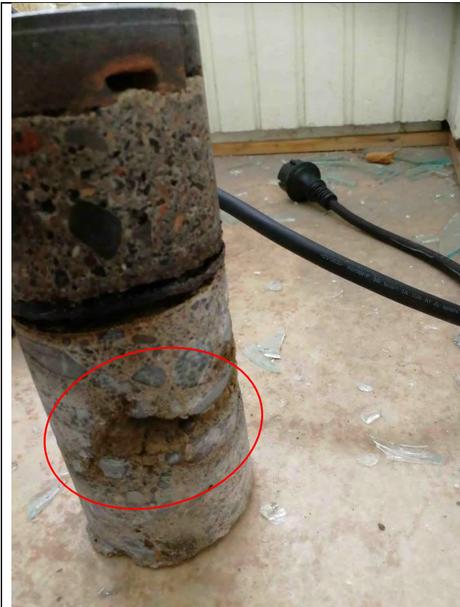
Pohjalaatassa hiekkapaakkuja betonin joukossa.
