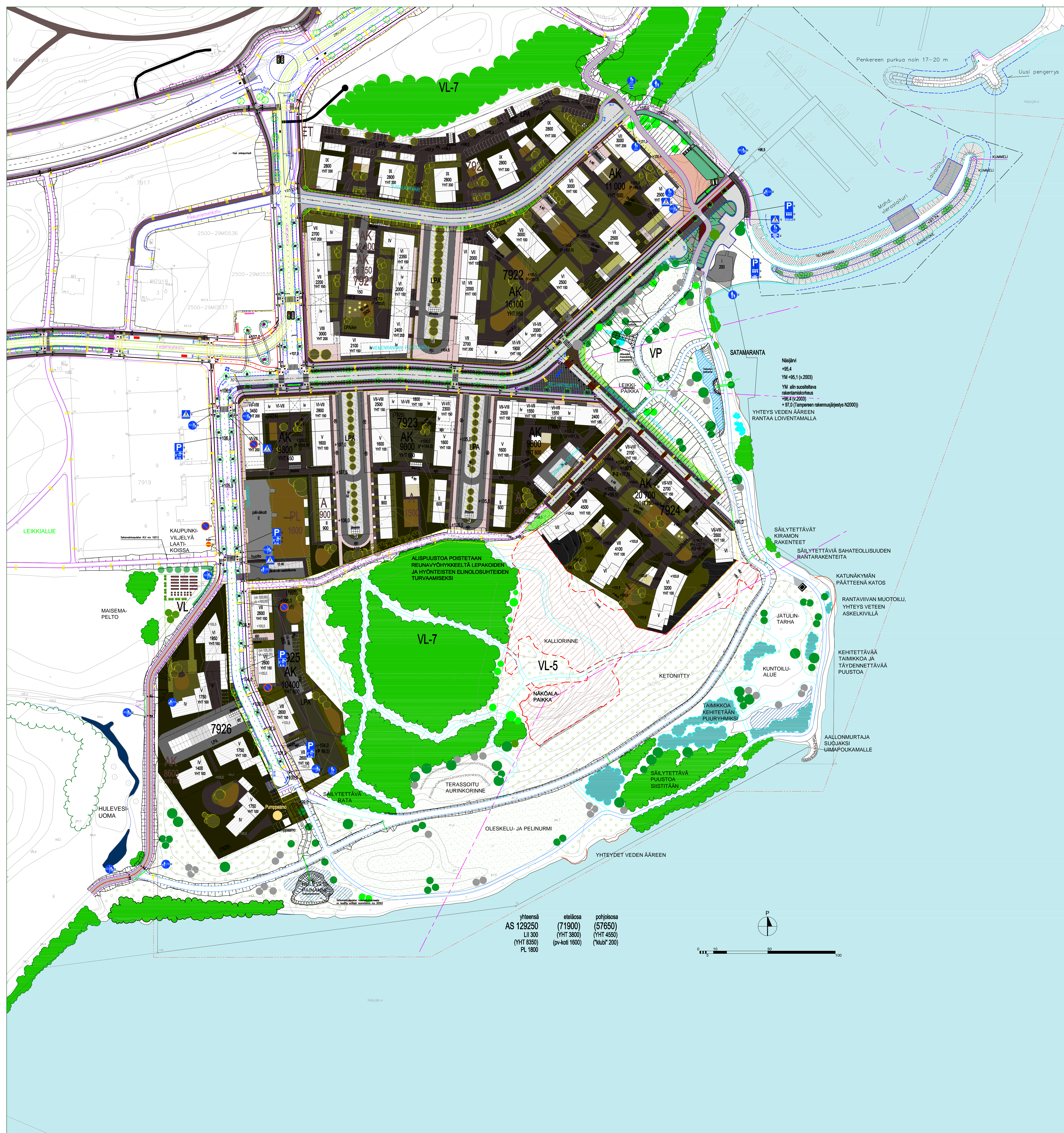
RANTATÖRMÄÄ LOIVENNETAAN MUUTAMISTA KOHDISTA JA VERHOILLAAN LUONNONKIVILLÄ AALLOKOKA KESTÄVÄKSI
