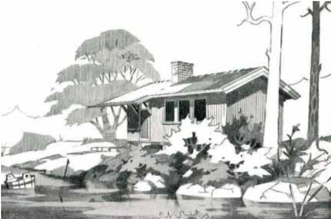
Puutalo Oy:n tyyppi "Saunakoto" 1950-luvulta. Rakennus on yhdistetty sauna ja kesämaja 24,5 m 2 ja sisältää saunan (A), olohuoneen (B) sekä eteisen (C), jossa on kaksi säilytyskomeroa. "Saunakotoa" valmistetaan kolmea eri kokoa, suurin on 28 m 2 ja siinä on olohuoneen yhteydessä kaksi ikkunallista makuukomeroa.
