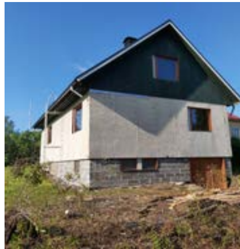
Puolitoistakerroksisten rakennuksen yläkerta on laudoitettu tummilla laudoilla ja alakerta verhottu levytyksellä. Ruotsalaisen mallin mukaan moniin jälleenrakennuskauden taloihin on laudoitettu yläkerta tummanruskeaksi ja alakerta on joko levytetty tai verhottu tiilellä. Kuvan talo sijaitsee Vesiperäncadulla ja on valmistunut vuonna 1920. Osoite Vesiperäncatu 9.
