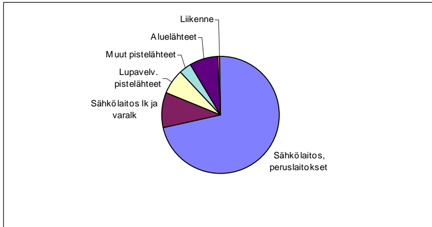
Kuva 1. Tampereen rikkidioksidipäästöt vuonna 2005, yhteensä 390 tonnia. Figure 1. SO 2 emissions in Tampere in 2005, total 390 tons per year.
